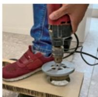
1. 左のようにインパクトドライバーにホールソーを装着し、それぞれのタイプに合った大きさの径で孔を開けます。
