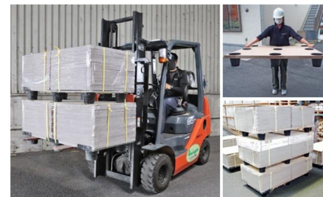
使用例：タイル積載例（1枚のパレットに800kgを積載）
